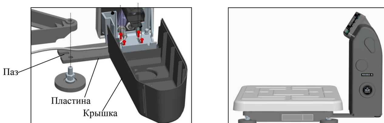
Рисунок 6 – Установка терминалов RL и R2L на модуль
