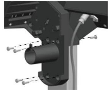
Рисунок 5 – Установка терминалов на прямоугольной стойке
