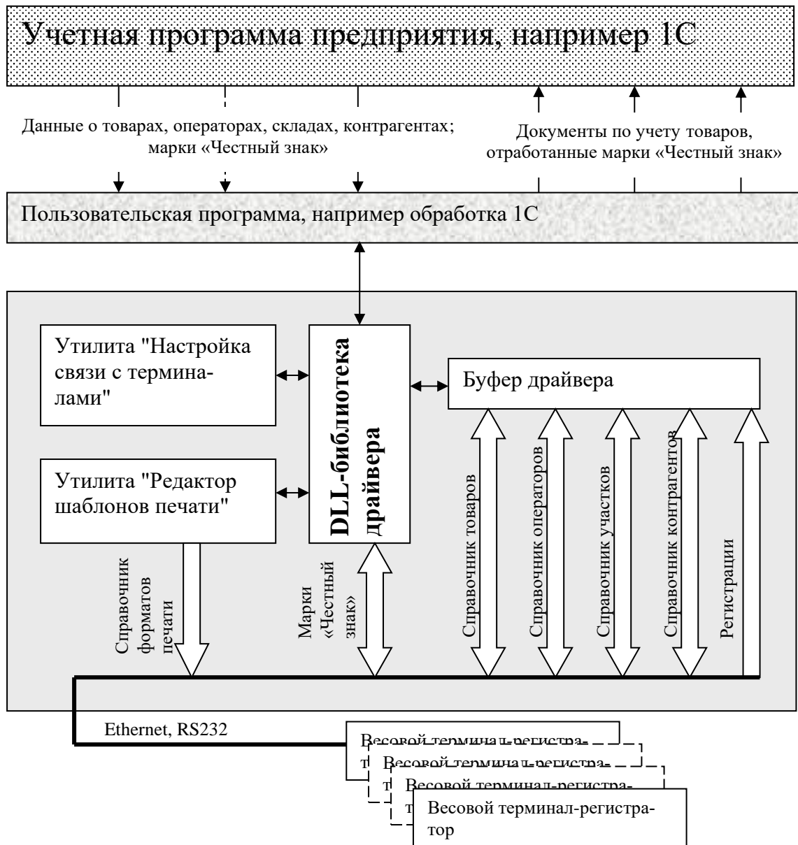
Рис. 2.1. Структурная схема работы драйвера "МАССА-К: Драйвер R."
